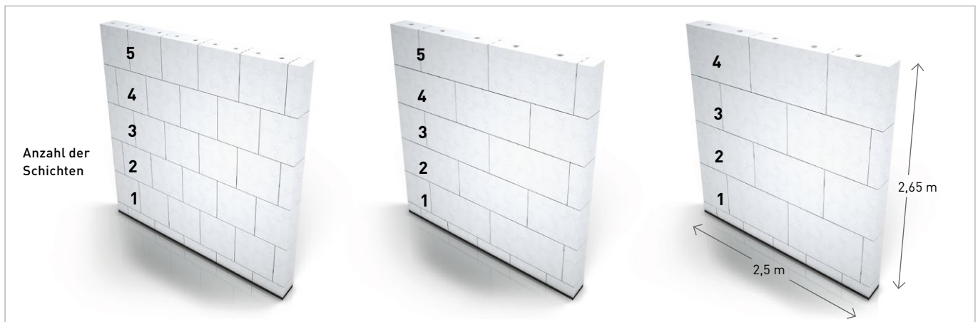
Die Abbildungen zeigen den Vergleich eines Wandausschnittes/Schichtenaufbaus aus Silka XL L x H = 498 x 498 mm (links), L x H = 998 x 498 mm (Mitte) und L x H = 998 x 623 mm (rechts) bei einer üblichen Geschosshöhe.
