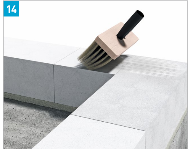
14 Bei Bedarf im Sommer gleichmäßig Vornässen
