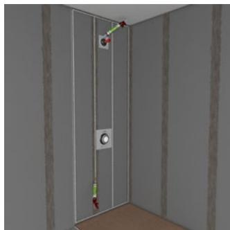
wedi 610 Kleb- und Dichtstoff auf dem abgedichteten Untergrund auftragen.
