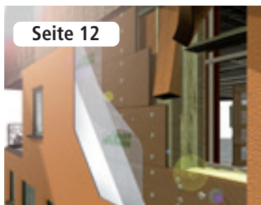
UdiSPEED® SYSTEM effizientes Wärmedämm-Verbundsystem für den Holzbau
