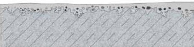
Sollte es nötig sein, große Flächen für eine Beschichtung vorzubereiten, ist das Kugelstrahlen die erste Wahl. Bei dieser Methode wird zunächst die oben liegende, mindere Qualität abgetragen. Instabile Teile werden entfernt.
