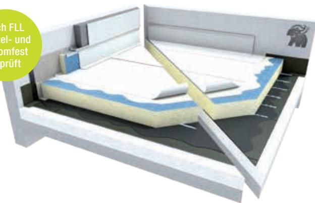
MECHANISCH BEFESTIGTER DACHAUFBAU\*
