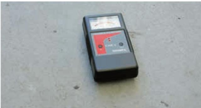
2. Der Untergrund darf zum Zeitpunkt der Beschichtungsarbeiten **maximal 5% (bezogen auf Masse) respektive 16% (bezogen auf Volumen)** Feuchtigkeit aufweisen. Mittels elektronischer Messmethoden kann dies hinreichend präzise und dabei zerstörungsfrei mit entsprechend hochwertigem Messgerät, bis zu einer bestimmten Tiefe ermittelt werden. Eine präzisere, von der Schichtstärke unabhängige Methode, ist das „CM-Verfahren“.
