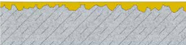
Die erzeugte Rauheit, gepaart mit der Tiefenwirkung des Strahlgranulats, erzeugt eine ideale Struktur. Das Grundierharz kann gut eindringen und bindet flächig auf dem Substrat ab.
