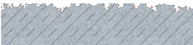
Durch das Schleifen mit einem Schleiftopf in Kombination mit einer entsprechenden Absaugung, wird der dünne Film an der Oberfläche entfernt. Die in den Poren liegende Verschmutzung wird in weiten Teilen abgesaugt.
