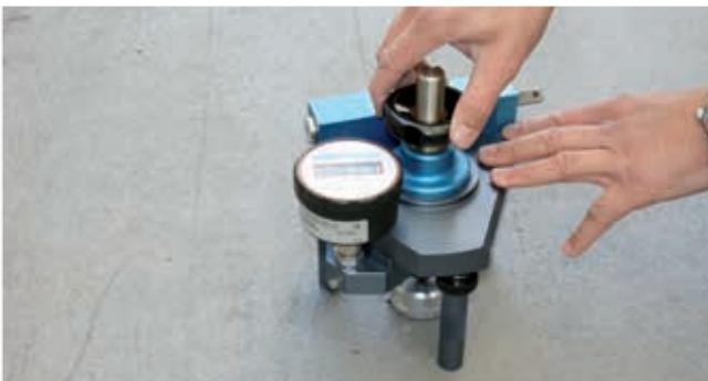
3. Voraussetzung für einen langfristigen Verbund zwischen Beschichtungsmaterial und Untergrund ist eine ausreichende Haftzugfestigkeit.
