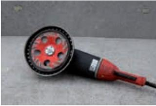
**1.** Der mineralische Untergrund ist durch Schleifen, Stocken o. Ä. so vorzubereiten, dass er tragfähig, trocken, fettfrei und frei von haftungsmindernden Bestandteilen ist. Bei Altbelägen und stark saugenden Untergründen ist unsere Anwendungstechnik zu kontaktieren. Merkblätter 101 und 102 beachten.
