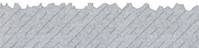
Es entsteht eine Rauheit mit relativ gleichmäßiger Oberflächenstruktur, die einen wesentlichen Beitrag zur Haftung leistet. Auch Poren, die nur noch eine sehr dünne Deckschicht haben, werden beim Kugelstrahlen aufgeschlagen.
