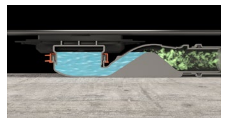
Permanenter Geruchsverschluss durch Wellenform
