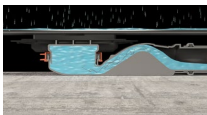
Selbstreinigungseffekt durch hohe Strömungsgeschwindigkeit
