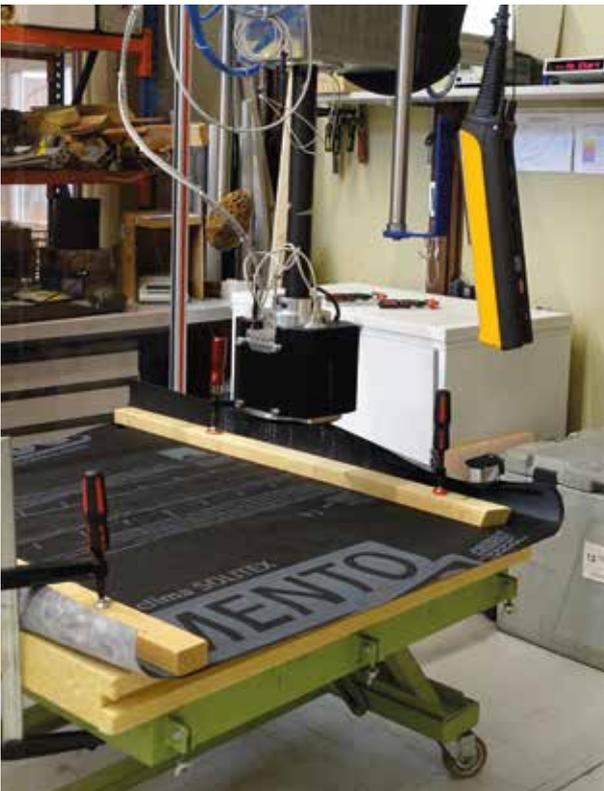
Mit einer Hagelkanone können Eiskörner mit Geschwindigkeiten von bis zu 110 km/h verschossen werden.
