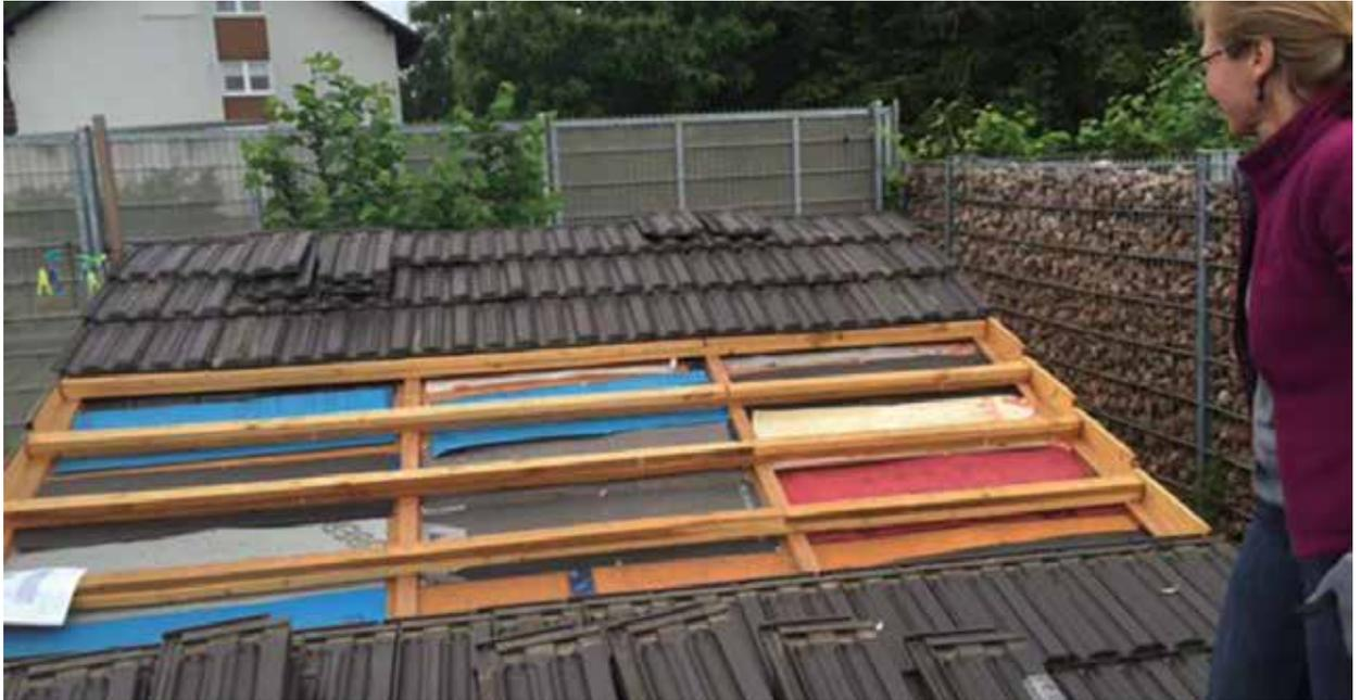
Untersuchung von frei gespannten Unterdach- bzw. Unterdeckbahnen verschiedener Hersteller 5 Jahre nach dem Einbau
