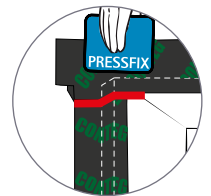
Obere Eckverklebungen herstellen
