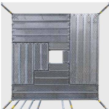
PERI UP bietet ein Grundraster von 25 cm. Die Vielfalt an Riegeln mit Längen ab 25 cm ermöglicht einen einfachen Richtungswechsel von Belägen. Dies sorgt für eine große Anpassungsfähigkeit an unterschiedliche Geometrien – nahezu kupplungs-frei. Belagebenen können mit Systembauteilen geschlossen werden. Selbst zu Störstellen beträgt der maximale lichte Abstand weniger als 25 cm.
