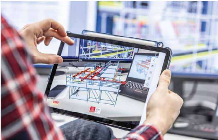
Mithilfe der Augmented Reality (AR) Darstellung können die Modelle in die Umgebung projiziert werden. Dadurch können die geplanten Lösungen in Echtgröße direkt in der Baustellenumgebung visualisiert werden.
