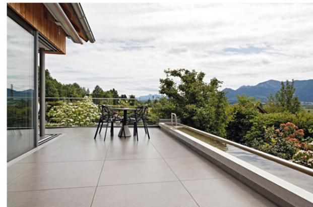
Auf Terrassen ist der Einsatz von keramischen Platten auf dem Vormarsch, da diese eine wesentlich geringere Wasseraufnahme vorweisen. Dazu gehören insbesondere die circa 2 cm starken, großformatigen Feinsteinzeugplatten (Outdoorkeramik).
