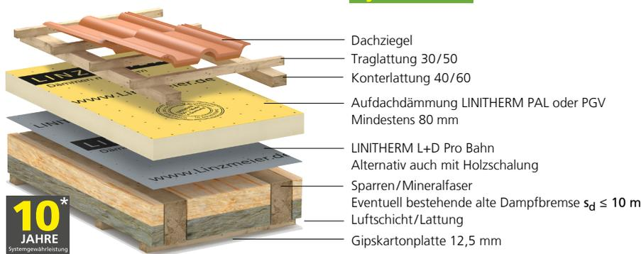
Die Dicke der Aufdachdämmung ist bei dieser Konstruktion abhängig von den wärme- und feuchteschutztechnischen Eigenschaften der raumseitigen Schichten. Je dicker die Aufsparrendämmung, desto sicherer wird der Aufbau. Der Einsatz von PAL oder PGV Aufsparrendämmungen ist bei vorhandenen/neuen Zwischensparrendämmungen bis 160 mm und  $\lambda_B \geq 0,035 \text{ W/(mK)}$  bereits ab einer Dicke von 80 mm möglich.
