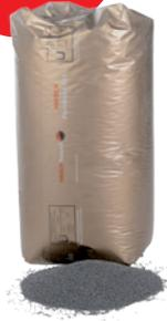
HIRSCH Porozell PoroBead® 033 ist ein Polystyrol-Partikelschaum-Granulat, das von HIRSCH Porozell EPS speziell für eine effektive, hohlräumfreie Verfüllung von zweischaligen Mauerwerken entwickelt wurde.
