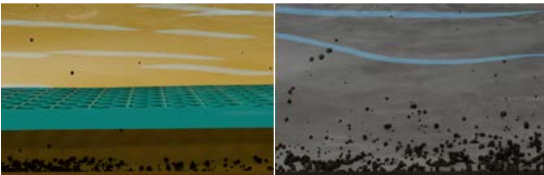
Sedimentierte Partikel verbleiben im strömungsberuhigten Bereich
