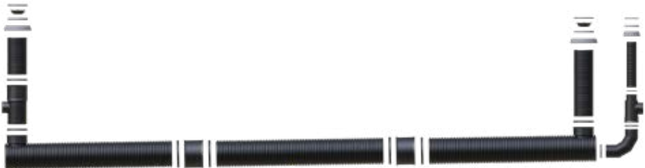
Modularer Aufbau einer SediPipe am Beispiel SediPipe 800/18
