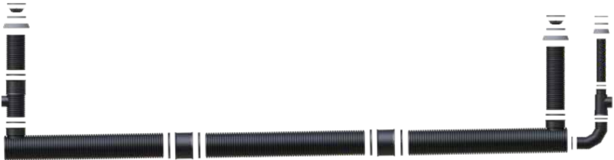
Modularer Aufbau einer SediPipe am Beispiel SediPipe 800/18
