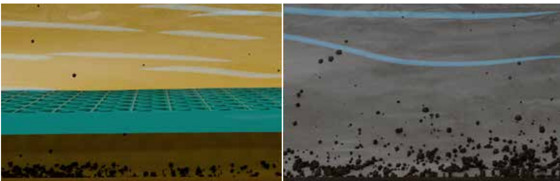
Sedimentierte Partikel verbleiben im strömungsberuhigten Bereich
