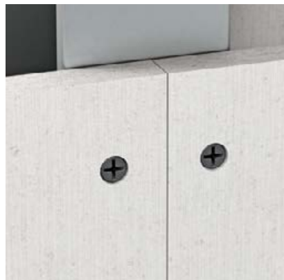
Plattenstoß dicht gestoßen – Fugenbreite: \leq 1 mm
