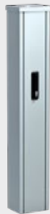
CRP-E03 Standsäule mit abnehmbarer Revisions- öffnung zum Einbau von bauseitigen Komponenten, max. Einbaumaße 170 mm x 140 mm x 150 mm (H x B x T)
