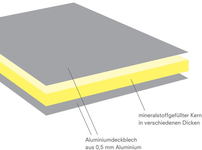
**ALUCOBOND® ist eine Verbundplatte aus zwei Aluminiumdeckblechen und einem nicht brennbaren bzw. schwer entflammablen mineralstoffgefüllten Kern, die sich durch ihr geringes Plattengewicht für vielseitige Anwendungen in der Architektur eignet – sei es für Groß- oder Kleinprojekte, Neubauten oder Sanierungen, Dachkonstruktionen, Innenanwendungen oder Corporate Design Programme.**
